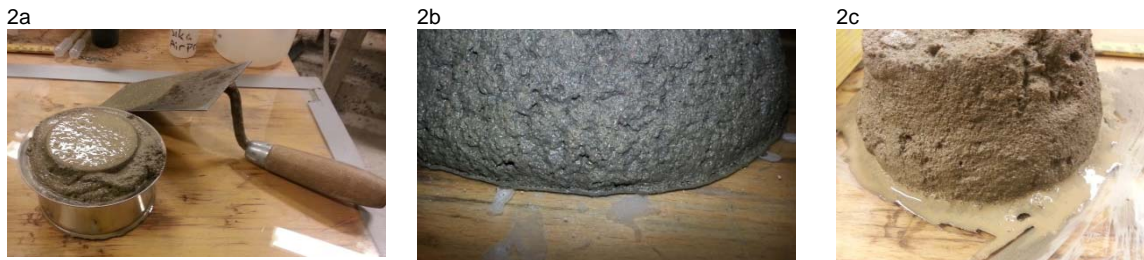
Figur 2. Mätning av arbetbarhet med Hägermannkon. 2a Hägermannkon. 2b Låg risk för vattenseparation. 2c Hög risk för vattenseparation.
