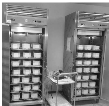
Figur 5. Provpuppställning i frysen under testet. 9 prov per hylla.
